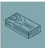
**MADEIRA MACIÇA** na base, fixa com grampos metálicos e cola PVA (própria para madeira) a união destes dois componentes confere à estrutura firmeza e estabilidade evitando rangidos e imperfeições na peça.
