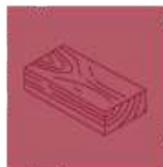
**MADEIRA MACIÇA** fixa com grampos metálicos e cola PVA (própria para madeira) a união destes dois componentes conferem à estrutura firmeza e estabilidade evitando rangidos e imperfeições na peça.
