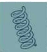
**MOLAS ESPIRAL.** Segmento feito de metal com mecanismo flexível, capaz de armazenar grande energia potencial elástica, sendo responsável por amortecimento, resistência ou impulso.
