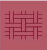
**PERCINTA ELÁSTICA** no assento faz a ligação entre o esqueleto e as camadas de conforto, garantindo o suporte necessário para as espumas e proporcionando melhor desempenho e durabilidade.
